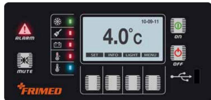
Pannello di controllo a microprocessore con **display digitale** facilmente visualizzabile. Visualizzazione menu, temperatura, impostazione, data e ora, modello dell'apparecchio.
